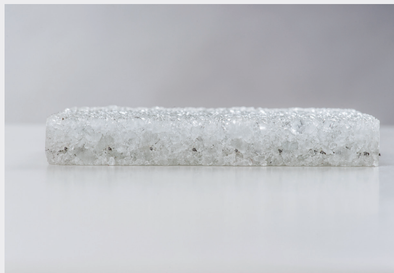
▲ Obr. 12. Detail struktury akustického obkladu Glasio
